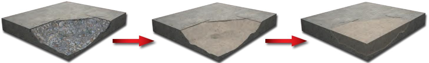
Cortar perpendicularmente, con herramienta adecuada, el perímetro de la zona a reparar y sanear la superficie hasta obtener un soporte sólido con un espesor mínimo de 5 mm en los bordes.
