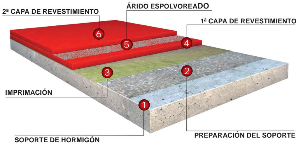
Estos sistemas consisten en aplicaciones de revestimientos de capa fina o gruesa de diversa naturaleza química con el espolvoreado de un árido duro de granulometría, color y naturaleza seleccionadas sobre la superficie de un revestimiento en estado fresco.
