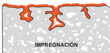
Las Impregnaciones (I) reducen la porosidad superficial y refuerzan la superficie. Los poros y capilares están parcial o totalmente rellenos. Este tipo de productos produce generalmente una película discontinua en la superficie del hormigón.
