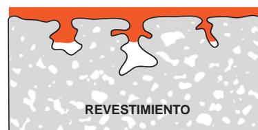
Los Revestimientos de Capa Fina (R-CF), los Revestimientos de Capa Gruesa (R-CG), y los Revestimientos de Múltiples Capas (R-MC) producen una capa protectora continua en la superficie del hormigón.
