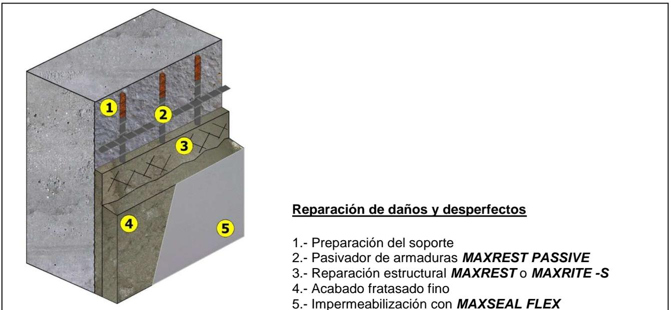
Figura 2.- Reparación de un soporte de hormigón, incluyendo tratamiento de las armaduras
